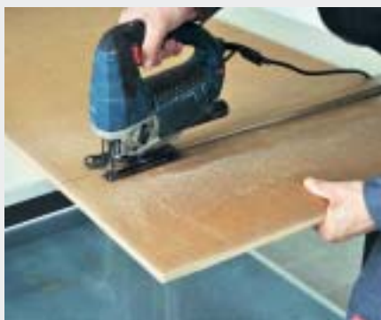
Formátování desky Wolf pomocí přímočaré pily.
